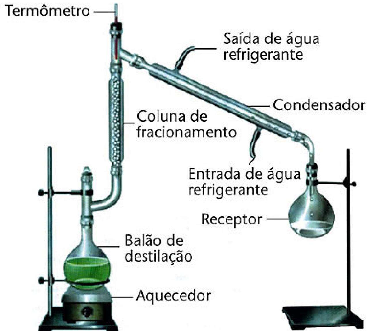
**Aplicação da destilação fracionada: lembre que cada bandeja funciona com se fosse uma coluna de fracionamento.**
